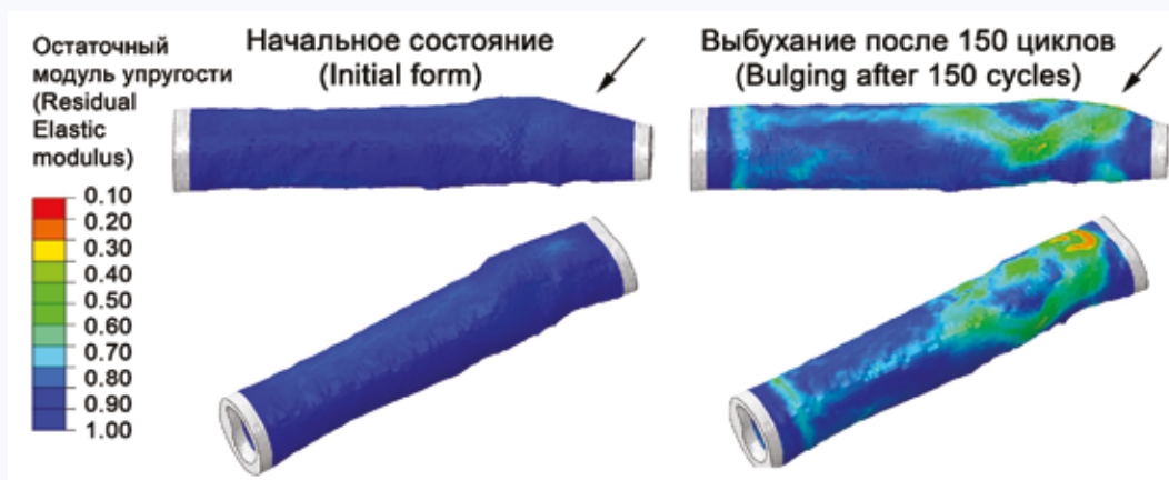
Рис. 4. Эпюры численного моделирования, визуализирующие степень деградации модуля упругости материала сосуда, в результате воздействия циклической нагрузки (условных 150 циклов приложения давления): начальное и итоговое состояние после моделирования Fig. 4. Diagrams of numerical simulation visualizing the degree of degradation of the elastic modulus of the vessel as a result of cyclic loading (conditional 150 cycles of pressure application): initial and final state after simulation
