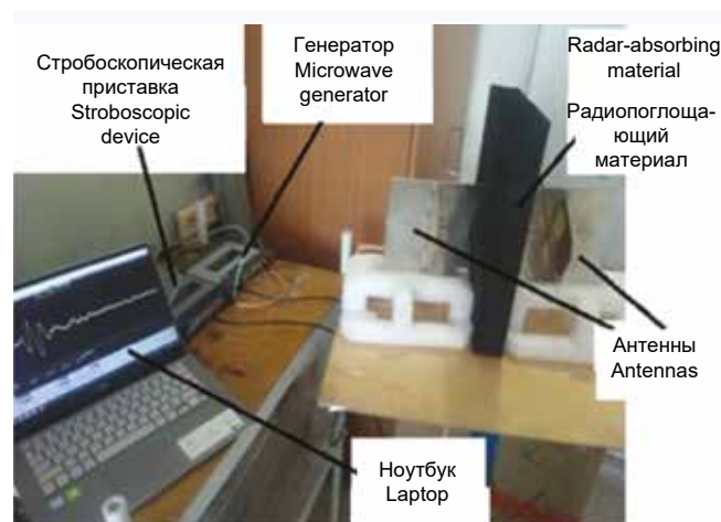
Рис. 3. Фотография экспериментальной установки Fig. 3. The photo of experimental facility
